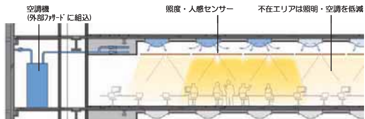
【クールビズに対応する放射併用空調、ライトビズに対応する照明システム、在室検知による照明・空調制御の概念図】
