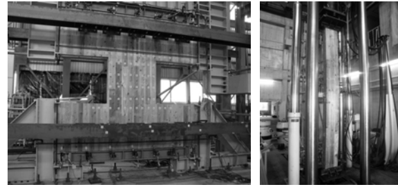
図 1 CLT の材料性能の評価試験の様子 （解説）左：面内せん断試験、右：座屈試験
