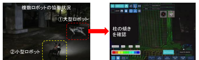
写真2 夜間時の複数ロボット・カメラによる遠隔臨場支援状況
