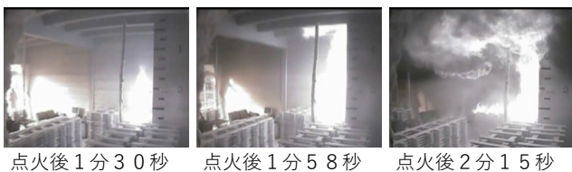
図1 木造三階建て学校実大火災実験（予備実験）
