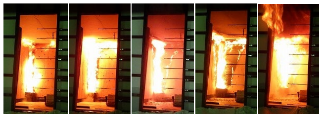
図 18 一時的な燃焼の緩慢後にフラッシュオーバーが生じる条件
