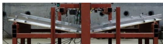
写真5 天井の勾配変化部を模擬した部分の曲げ実験
