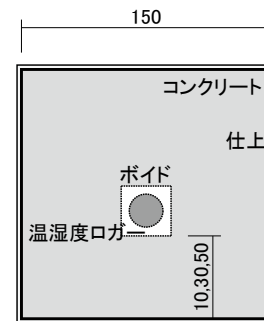
上面（打込み面）
