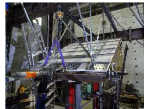
写真1 山形の天井試験体 (No.2~5)
