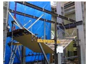
写真2 谷形の天井試験体 (No.6,7)
