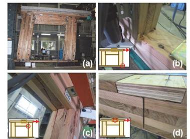
図5 垂れ壁付きフレームの破壊性状
