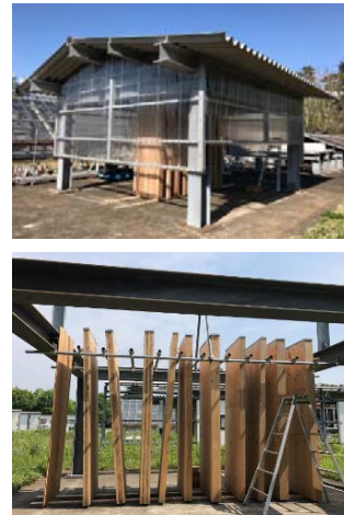
写真2 降雨のない外気曝露環境(上)と屋根なしで雨水が作用する曝露環境(下)
