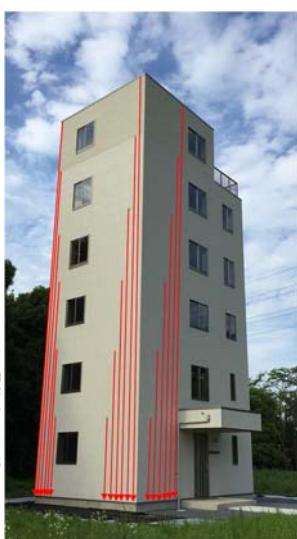
写真 3 枠組壁工法 6 階建て実大実験棟の外観と沈み込み測定イメージ
