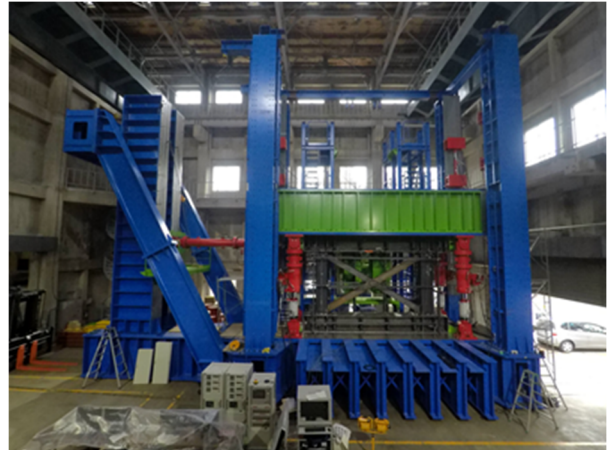
写真 1 大型加力装置外観（正面）
