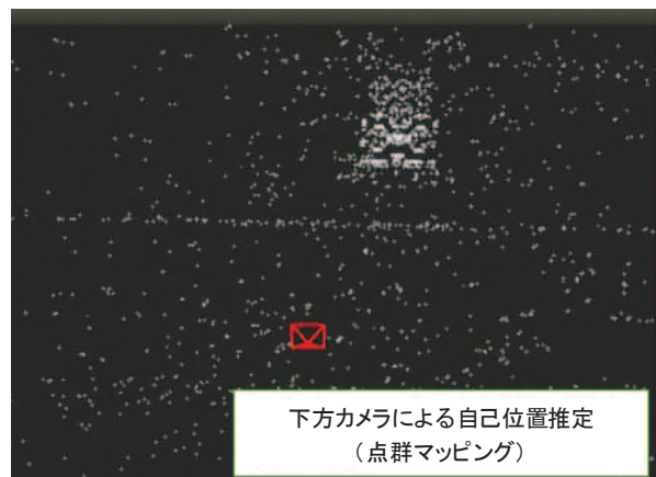
図21 Visual SLAM型ドローンに搭載した可視カメラ、及びステレオカメラの撮影・特徴点抽出の状況
