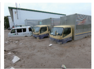
写真 4.28 車輪の大部分が土砂で埋まった貨物車
