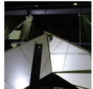
写真7 最終形 天井面の下地材への接触
