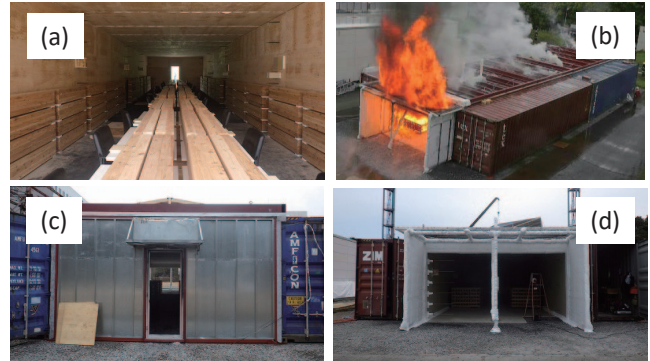
(a) 可燃物の配置状況（木材クリブ）、(b) 実験の外観、(c) 放水側の開口の様子（図2左側）、(d) 開放側の開口の様子（図2右側）
