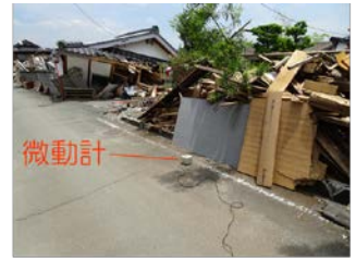
使用した微動計(同型機)とH地点の観測風景
