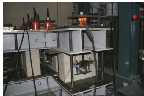
写真2 せん断クリープ試験の状況
