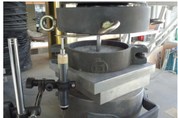
写真3 押し抜き試験の実施状況
