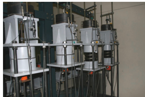
写真1 引張クリープ試験の状況
