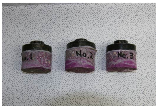
写真3 求道学舎外壁の接着力試験後の状況
