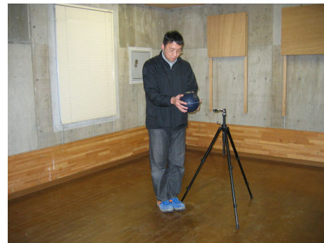
写真2 標準重量衝撃源（ゴムボール）
