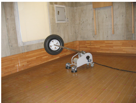
写真1 標準重量衝撃源（自動車用タイヤ）
