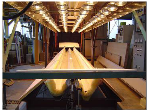
写真 5 折板屋根ふき材の温度伸縮実験
