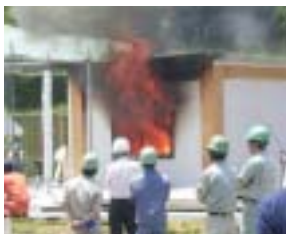
写真 7, 1時間耐火構造の実大火災実験
