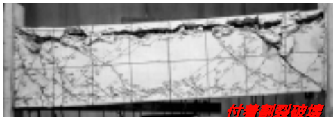
鉄筋コンクリート造の梁： 付着割裂破壊により、損傷が大きい
