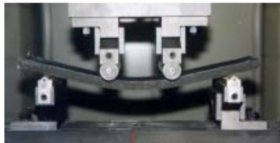
図 - 4 高靱性セメント複合材料(HPFRCC)の曲げ試験の状況
