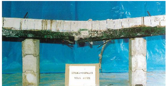
図—2 連続繊維補強コンクリートを使用した梁部材の曲げ耐力試験の様子
