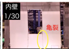
木造軸組耐力壁の加力実験
