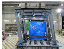
S造引張ブレースの振動台実験
