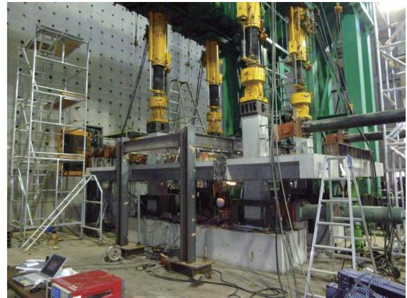
写真1 RC造部分架構実験
