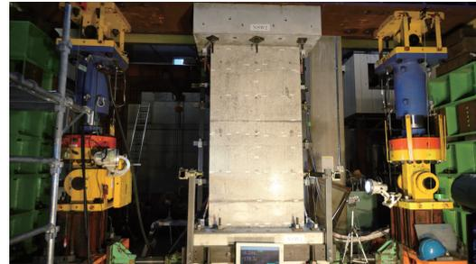
写真 1 実大方立て壁の要素実験
