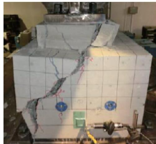
写真 3 実大 RCS 接合部の要素実験
