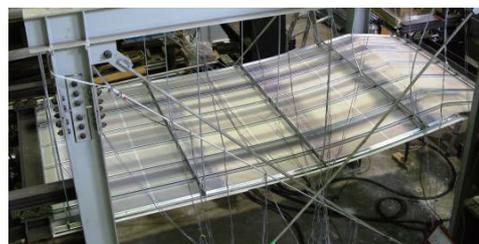
写真1 耐力の検討：面内圧縮実験
