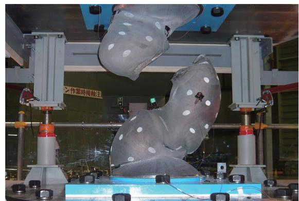
写真 2 鉛ダンパーの破断の様子
