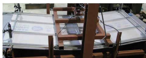
写真2 耐力の検討：曲げ実験
