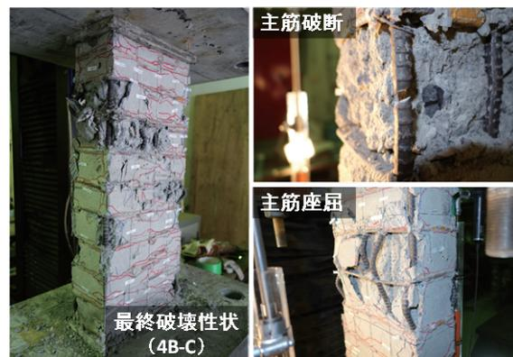
図 2 破壊状況
