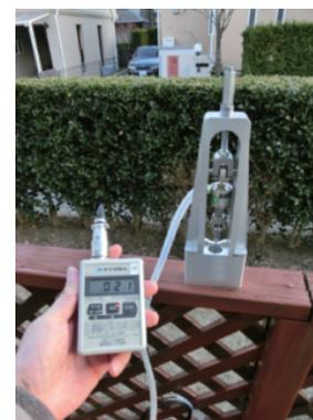
写真2 携行型引抜試験器
