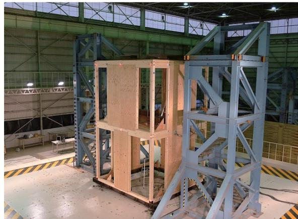
図4 振動台実験試験体
