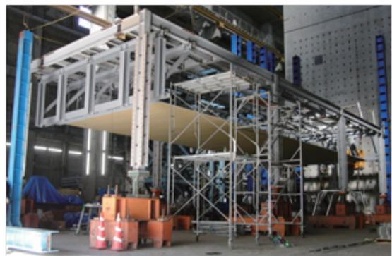
図 5 大規模天井の加振実験
