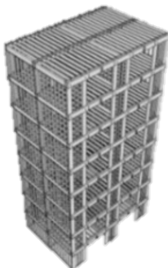
集成材構造 構造計算モデルの例
