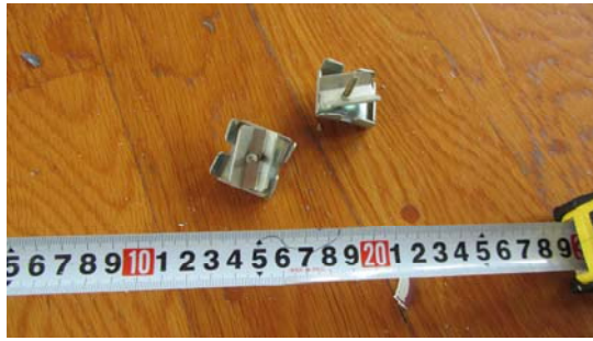
写真 4.1.12-8 多数落下していた金具
