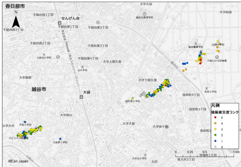
図 3.2 強風被災度ランクによる被害分布（越谷市）
