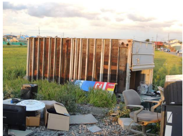
写真 4. 4. 2 転倒した鋼製コンテナ (2)
