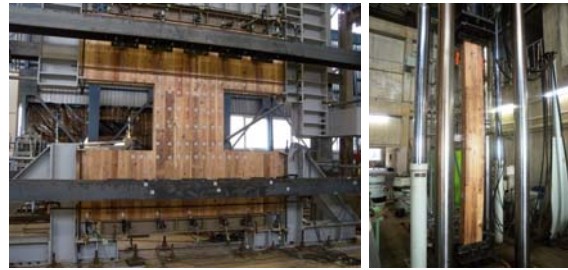
図2 CLT の材料性能の評価試験の様子 (解説) 左: 面内せん断試験、右: 座屈試験
