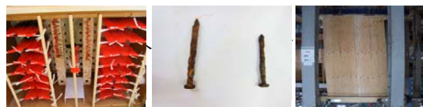
図3 塩水噴霧による釘の促進劣化と壁水平せん断試験の様子
