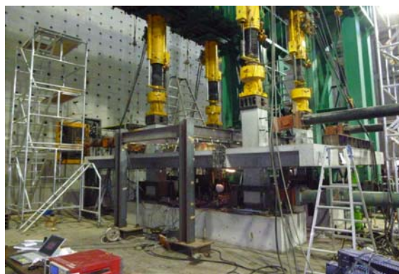
写真1 RC造部分架構実験
