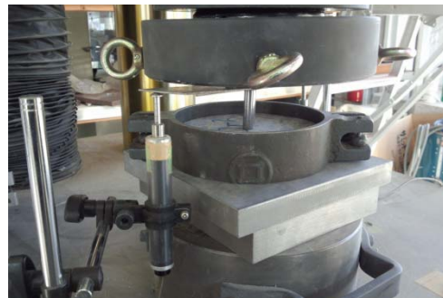
写真1 耐アルカリ試験の実施状況
