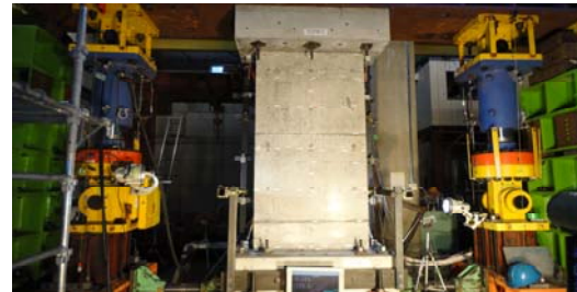
写真 1 実大方立て壁の要素実験
