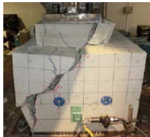
写真 3 実大 RCS 接合部の要素実験
