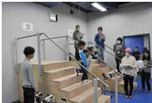
■ 写真3 階段の蹴上げ寸法に関する検証実験(左:検証実験の様子、右:階段昇降時のつま先の軌跡)
