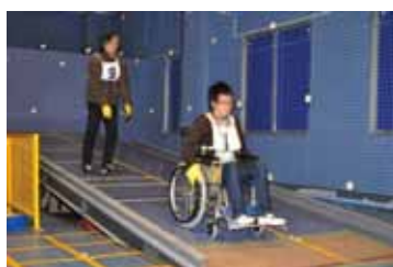
■写真1 実験の様子(左:勾配可変デッキを用いた実験の様子、右:踊場での操作と制動距離・走行軌跡の例 ※図中の破線は斜路終端から1.5mのラインを示す)
