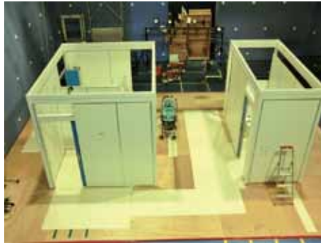
■ 写真2 トイレブースに関する検証実験(左:試験体配置風景、右:トイレブース内での検証実験の様子)
