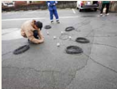
写真1 地表面の微弱振動の計測
