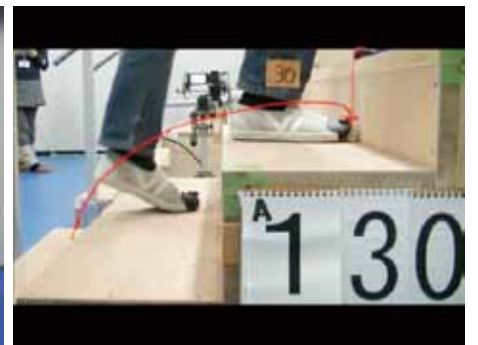
■ 写真3 階段の蹴上げ寸法に関する検証実験(左:検証実験の様子、右:階段昇降時のつま先の軌跡)
