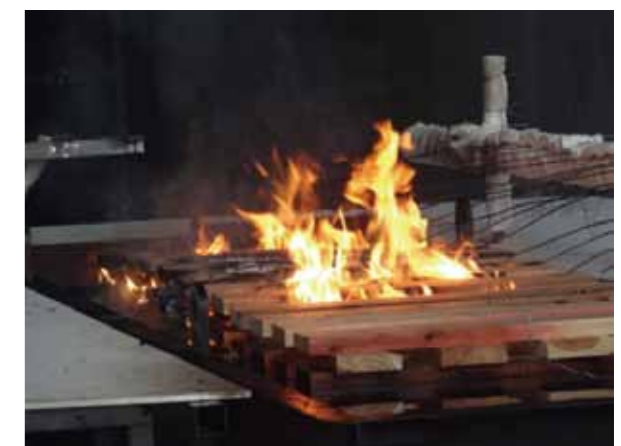
■写真5 津波被災後の海上瓦礫火災実験の様子
