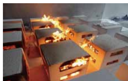
■ 写真3 縮小模型を用いた市街地火災実験の様子
