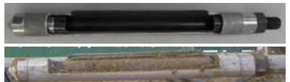
■ 写真3 SWS 試験用サンプラーと採取試料の例 (直径約 22mm, 長さ約 260mm)
