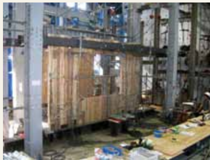
写真2 CLTパネルの加力実験
