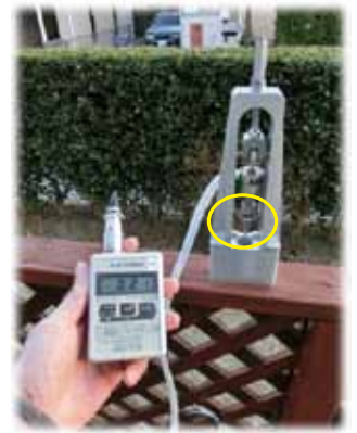
■ 写真3 ポータブル引抜試験器と強度表示計 （○部で、試験器のフックとプローブ頭部を結合）
