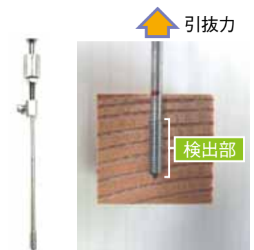
(a) プローブ (b) 木材中のプローブ ■ 写真2 標準プローブ （プローブ検出部のねじ山の間にめり込んだ木材が、引抜力に対して抵抗する）
