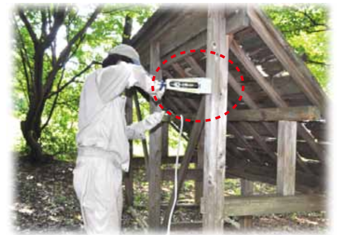
■ 写真4 ポータブル引抜試験器上部のハンドルを回してプローブを引抜き、引抜強度を測定する様子
