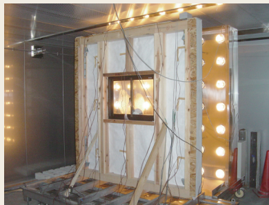
写真2：実大壁の促進劣化試験の様子（照射中）
