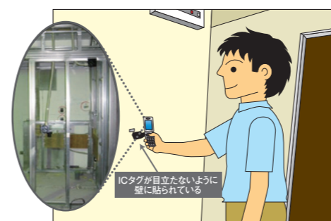
図7 壁に貼られたICタグを読み、壁の中の情報を取得する。
