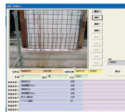
図9 検査結果に関する情報の例 (配筋検査の結果が表示される)
