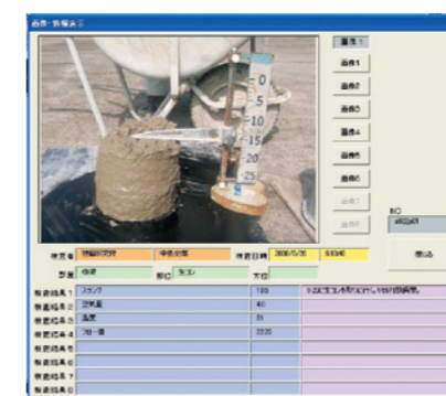
図8 検収結果に関する情報の例 (コンクリートの各種性能に関する検査結果が表示される)
