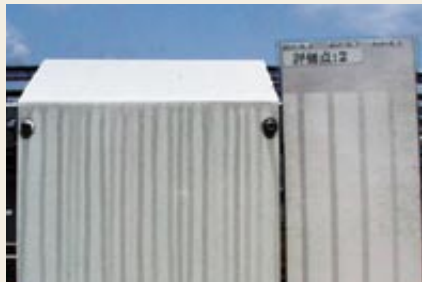
屋外暴露試験により発生した塗膜の雨筋汚れとその評価見本帳
