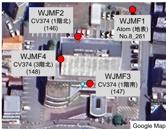
図 4. 4-5 WJMF 強震計・地震計設置位置
