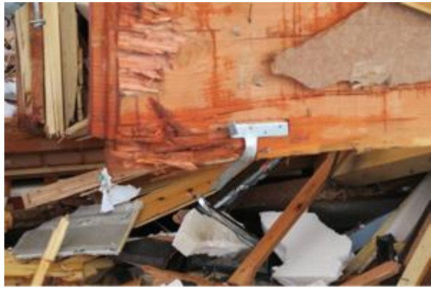
写真5.2.2-47 写真5.2.2-44のかど金物（T型）
