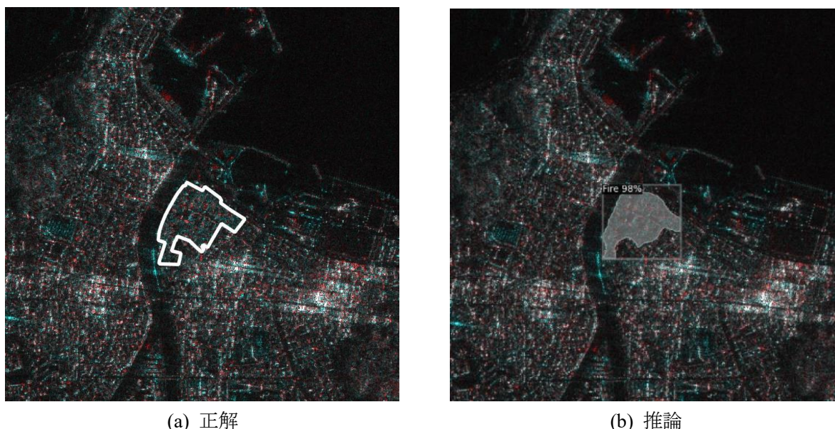
図 6.3.1-5 輪島市河井町の大規模火災を対象とした衛星 SAR による火災範囲の検出結果 (背景：ALOS-2 による 2024/1/9 及び 2021/10/19 の観測データ 6-11) に基づく疑似カラー画像)
