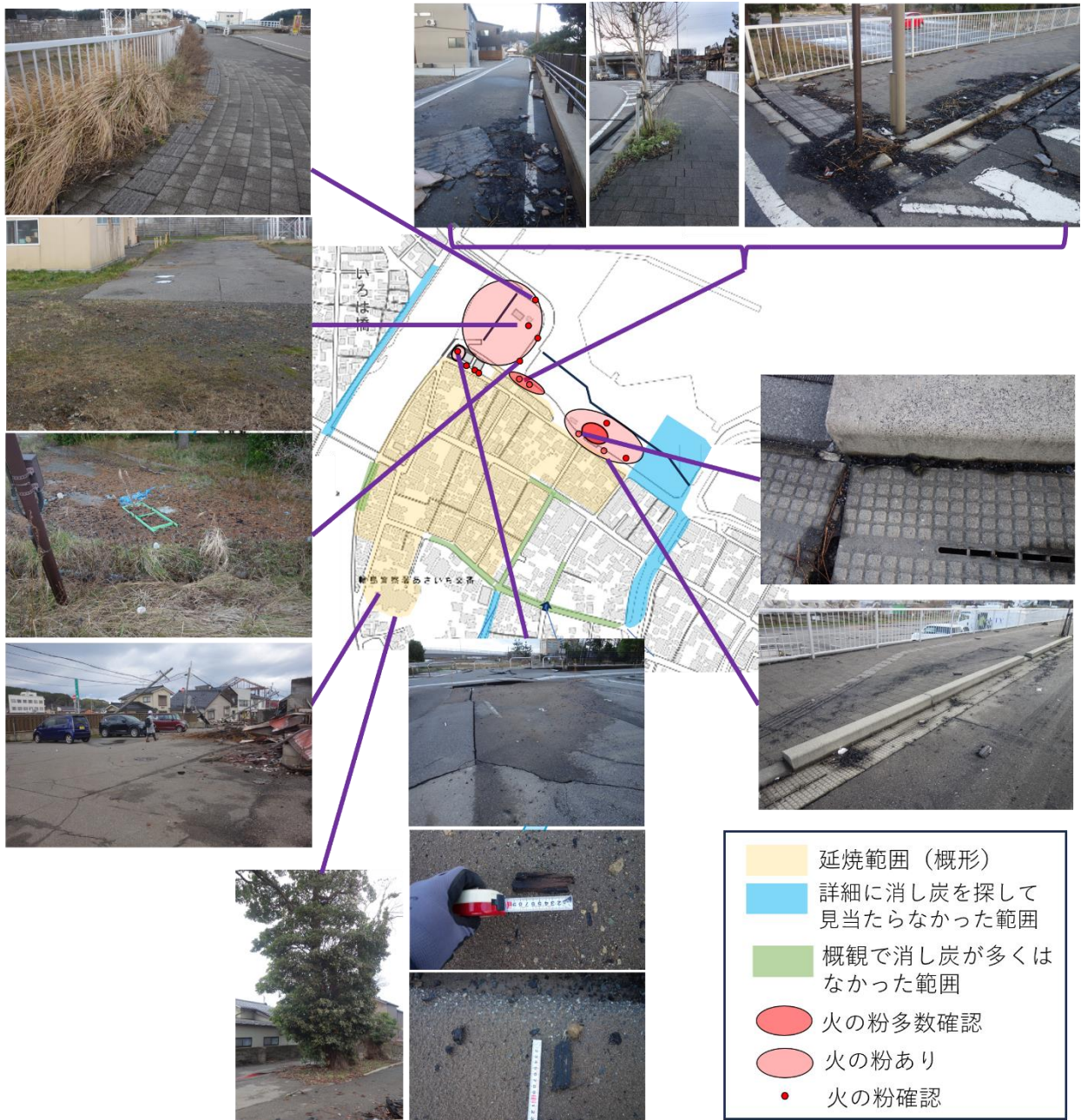
図 6.2.3-2 焼失区域北部の消し炭の飛散状況（背景地図：地理院地図 6-8) ）
