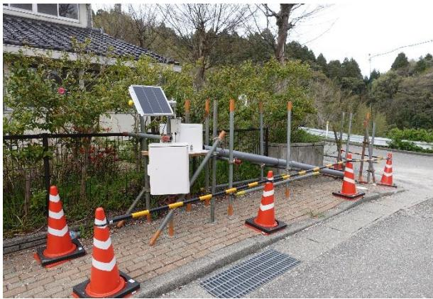
写真 5.3.2-188 地盤変位のモニタリング
