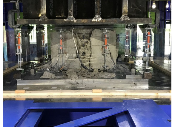
(b) 破壊状況：かぶりコンクリート剥離状況（一例）
