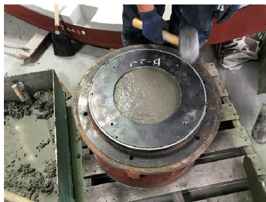
(d) 上部端板設置状況
