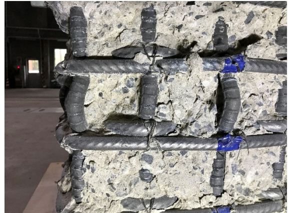
(d) 破壊状況：鉄筋変形状況（(c)拡大）
