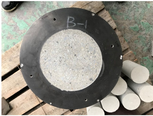
写真 2. 2. 6-10 B-1, B-2-1, 2 及び B-3 上面のコンクリート仕上げ状況の例
