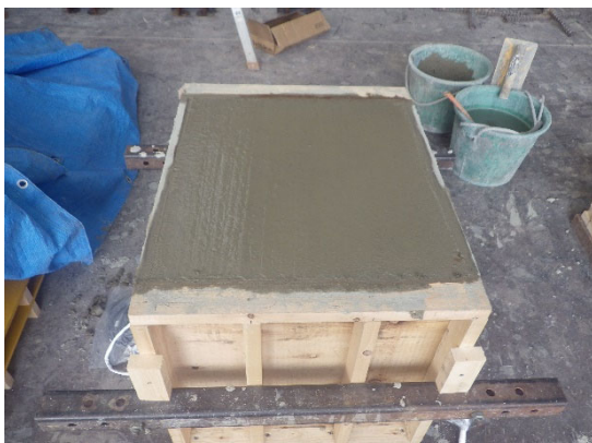
(e) 側面仕上げ状況
