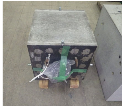
(b) 変位計設置用高ナット取付け状況
