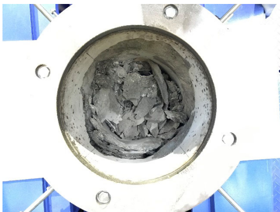
(c) 破壊状況：中空部破壊状況
