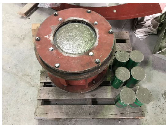
(e) コンクリート打設及び型枠組完了状況
