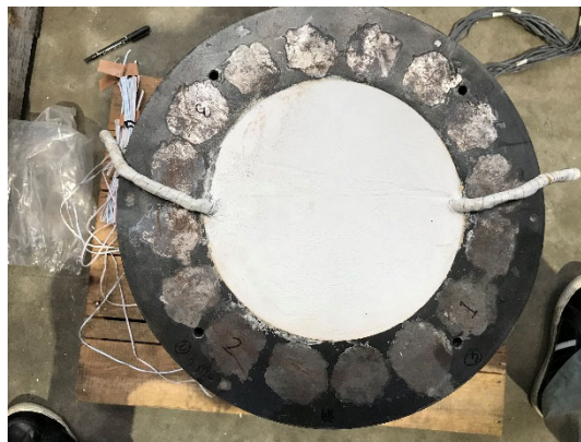
写真 2. 2. 6-13 試験体上面のコンクリート部仕上げ状況 : B-2-3
