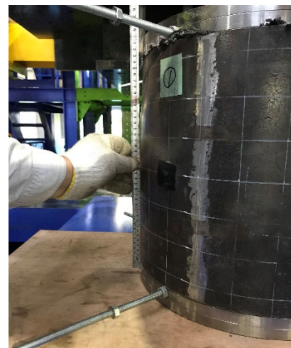
(d) 破壊状況：鋼管変形状況（一例）
