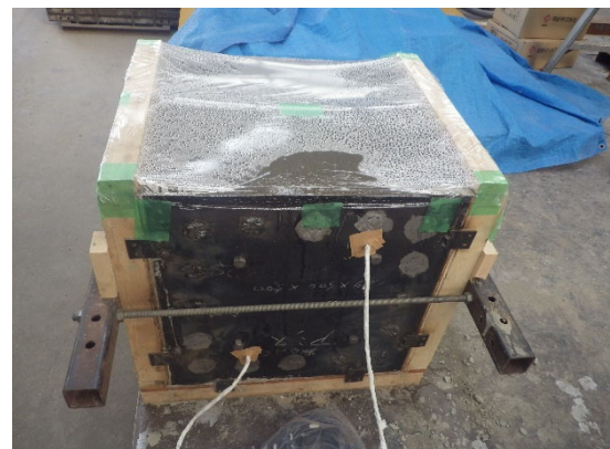
(f) 養生状況
