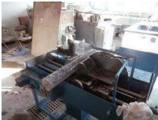
写真 9.2.8 コンクリートコアの切断作業
