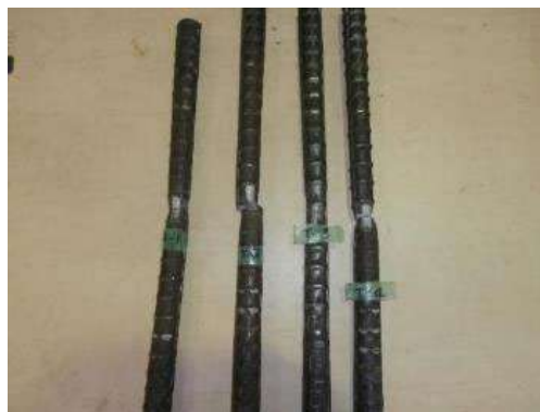
写真 9.2.17 破断後全試験体
