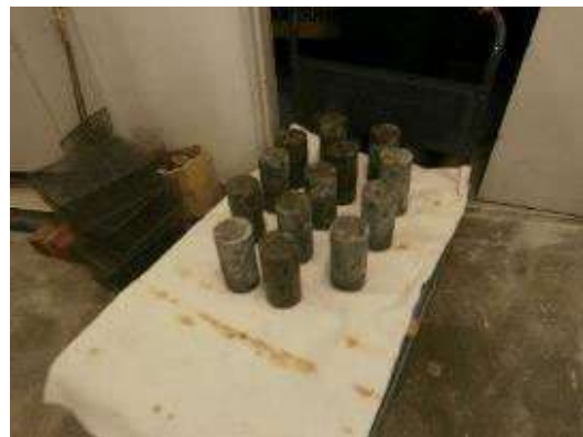
写真 9.2.9 コンクリートコア供試体の研磨
