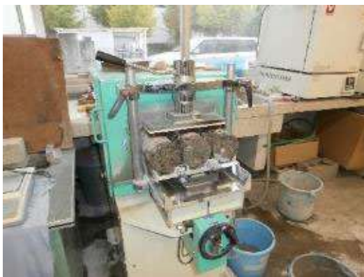
写真 9.2.9 コンクリートコア供試体の研磨
