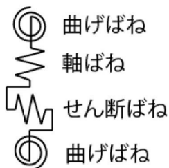
図 6.4.50 部材のばねモデル化
