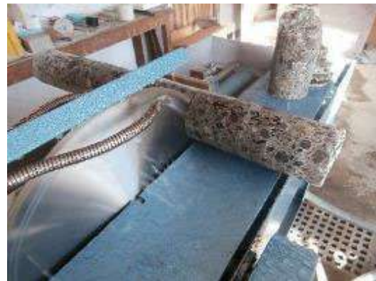
写真 9.2.8 コンクリートコアの切断作業
