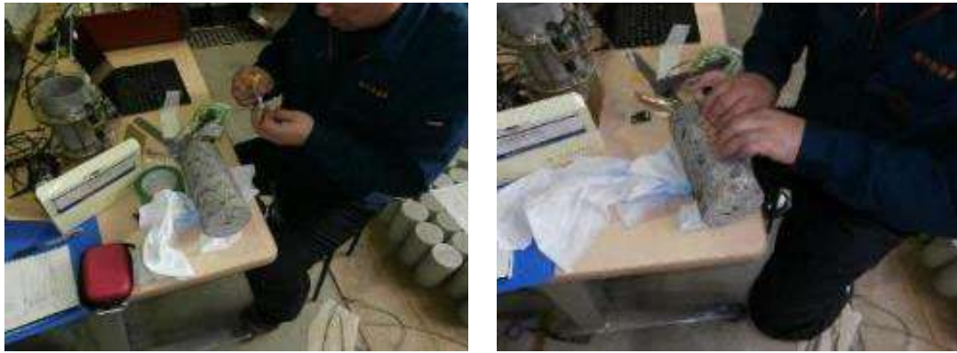
写真 9.2.10 ひずみゲージ接着
