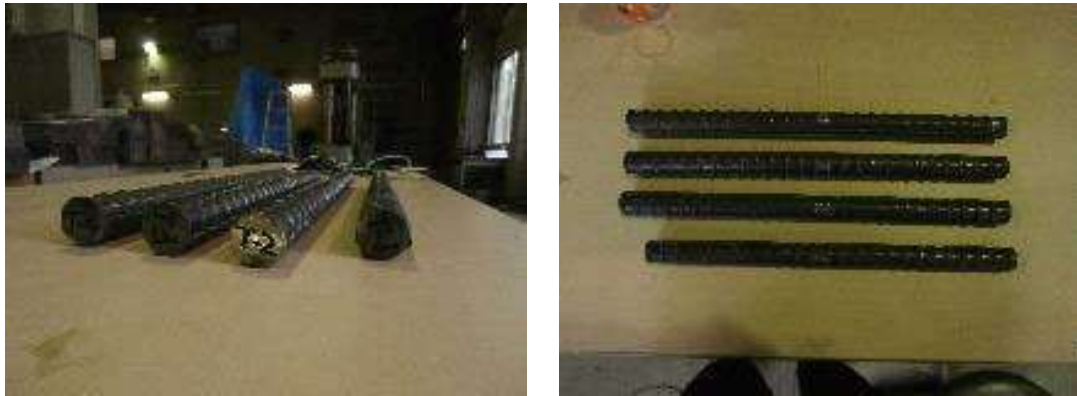
写真 9.2.14 引張り試験用鉄筋の供試体の確認
