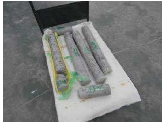
写真 9.2.7 コンクリートコア状況の確認
