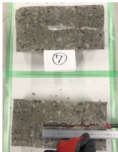
写真 5.5.2.5 接着剤充填状況(ホットドッグ)
