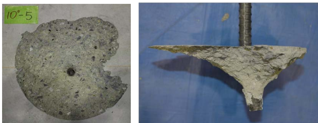
(c) 傾斜角 10° のコーン状破壊形状
