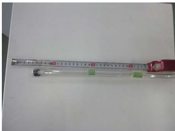
(e) 注入樹脂量を計算した後にマーキング
