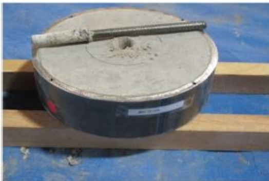
付写真 4.5.13 エポキシ樹脂 1-フィラー50%-①
