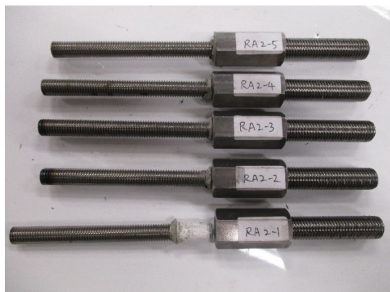
写真 3.8.1 接着力試験における破断面の例
