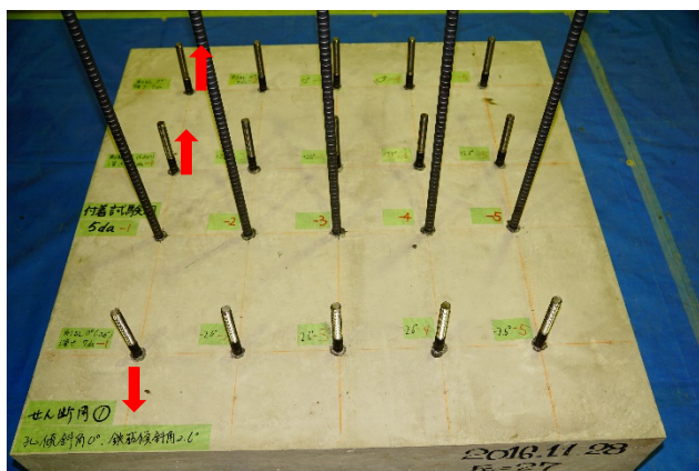
(c) 上段：傾斜角 0^\circ ，2 段：傾斜角 +2.2^\circ 3 段：付着試験用，下段：傾斜角 -2.2^\circ * 矢印：加力方向
