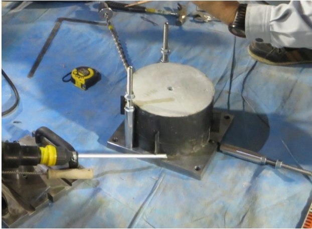
写真 2.2.2.1-1 試験体の固定状況
