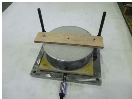
写真 2.3.2.1 垂直穿孔治具供試体セット状況
