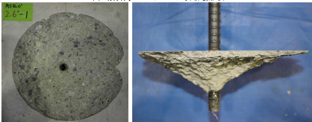
(f) 傾斜角 2.2° のコーン状破壊形状
