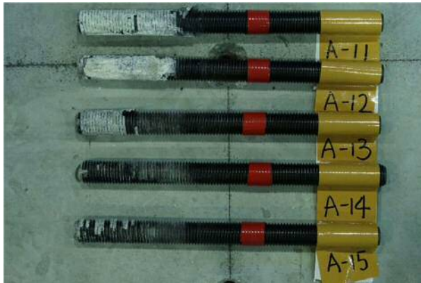
付図 4.2.8 最終破壊状況 ( F_c36 , エポキシ)
