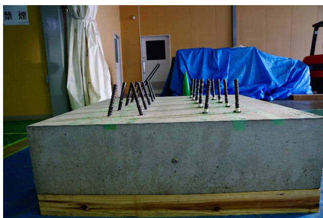
図 5.3.4.4 引張試験に使用したアンカー筋
