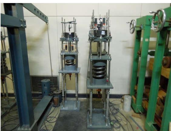
写真 2.2.2.3-3 クリープ試験実施状況 (20℃)
