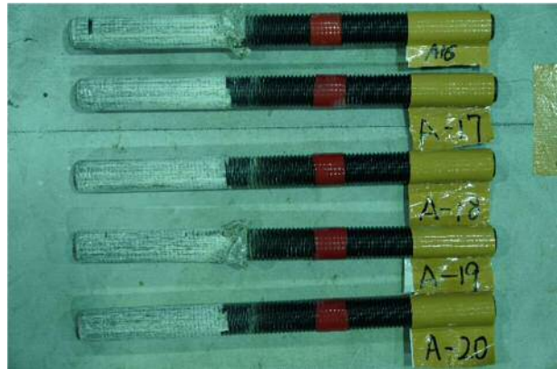
付図 4.2.9 最終破壊状況 ( F_c27 , セメント)
