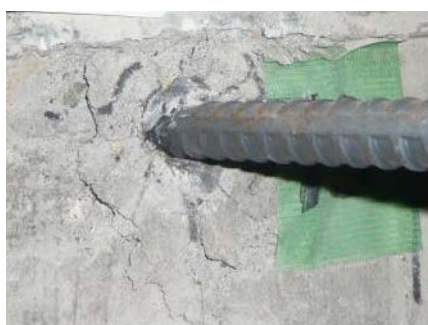
写真5.2.3.4-5 「表層剝離」の例（壁, No. 18） 写真5.2.3.4-6 「表層コーン」の例（壁, No. 31）
