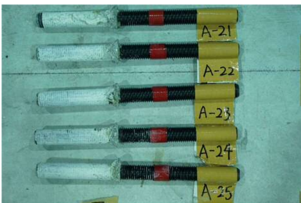
付図 4.2.10 最終破壊状況 ( F_c27 , エポキシアクリレート)
