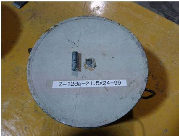
付写真 4.1.19 水準 20_S27・M12・10da (アンカー筋破断状況)
