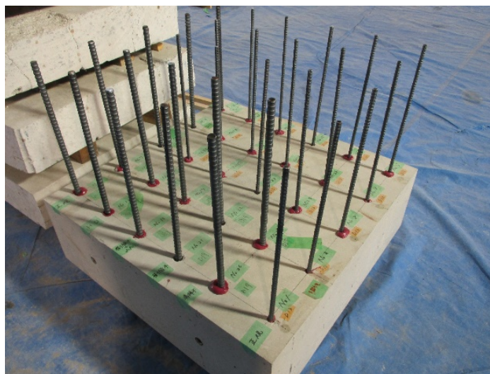
写真 5.5.2.1 コンクリート塊試験体の施工後の状況
