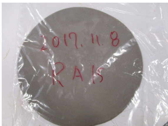
写真 3.7.7 ラジカル反応系樹脂接着剤による樹脂板
