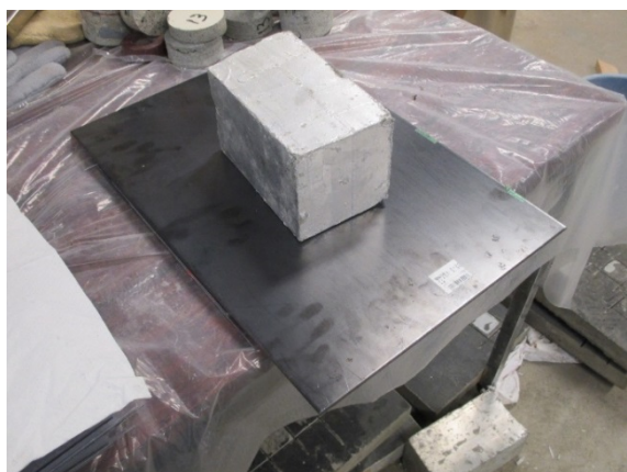
写真 3.7.5 重石による固定と硬化
