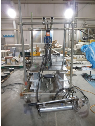
写真 2.2.2.1-5 荷重試験装置（異形鉄筋）
