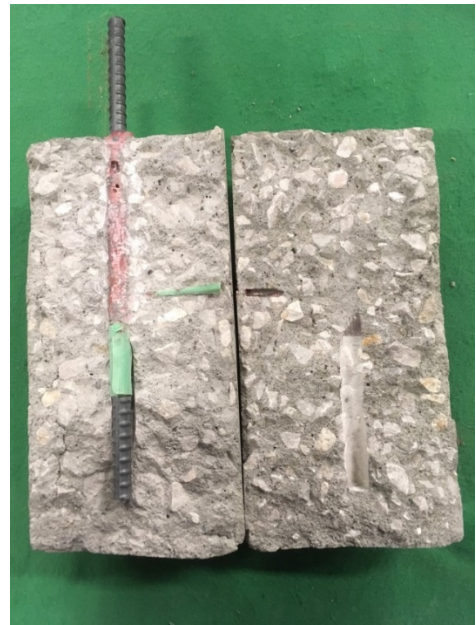
写真 5.4.2.1 手前側充填の再現状況
