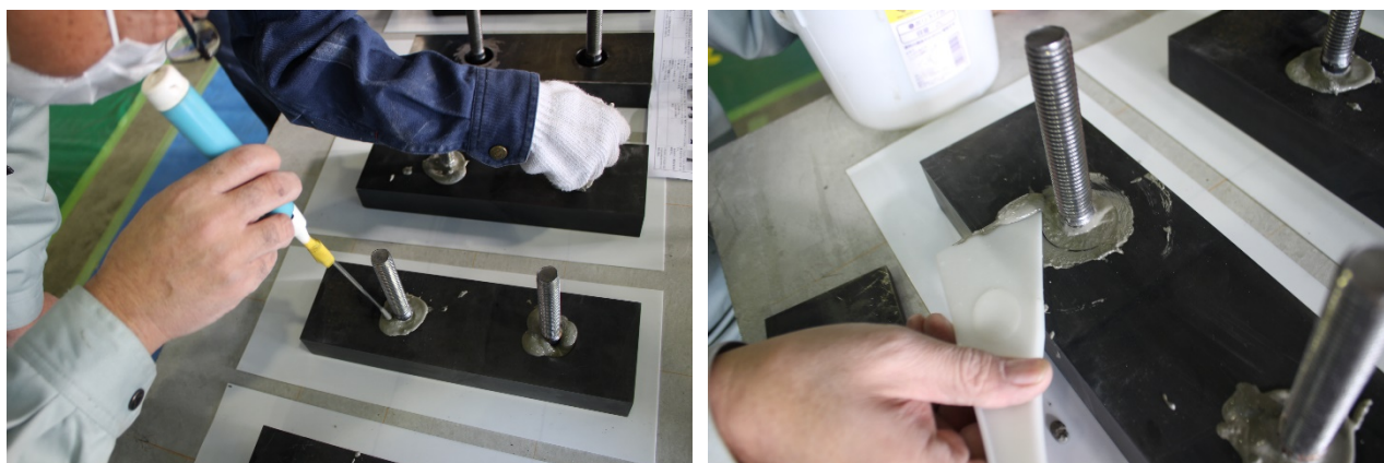
図 5.3.4.10 加力用鋼板内の無機系樹脂の注入状況
