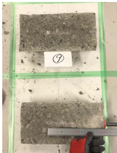
写真 5.5.2.6 接着剤充填状況(上向き樹脂量不足) 写真 5.5.2.7 接着材充填状況(清掃不良)
