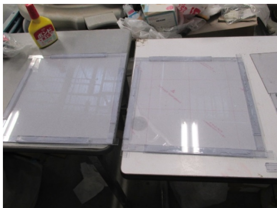
写真 3.7.1 樹脂板製作用型枠
