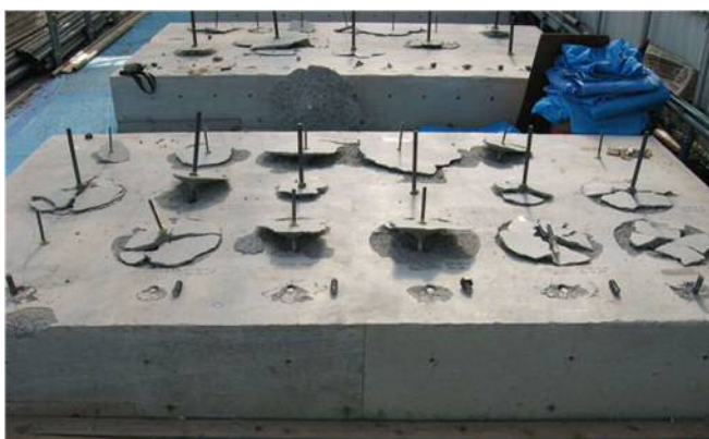
付写真 1.1.3 破壊状況の一例
