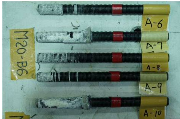
付図 4.2.7 最終破壊状況 ( F_c27 , エポキシ)
