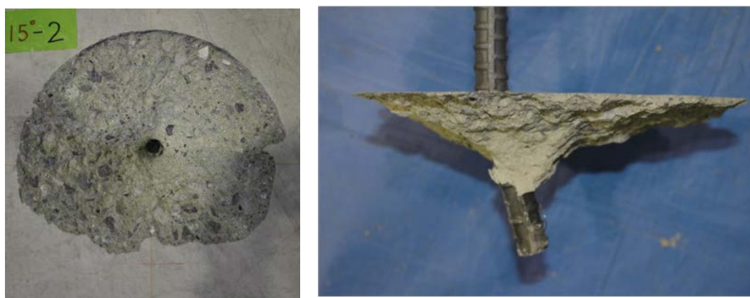
(d) 傾斜角 15° のコーン状破壊形状
