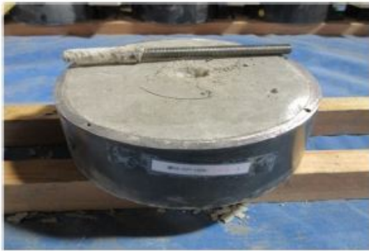
付写真 4.5.9 エポキシ樹脂 1-フィラー200%-①
