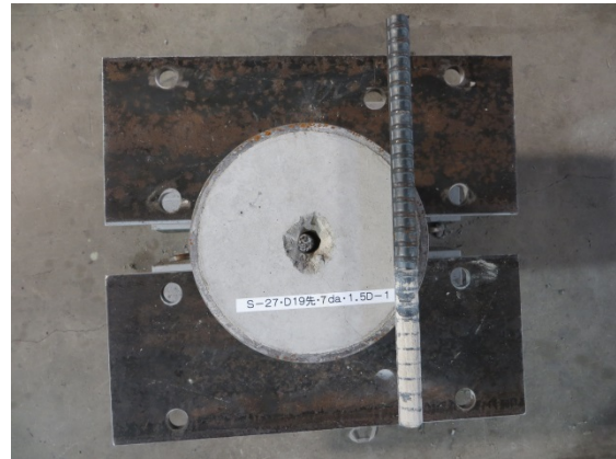
写真 2.2.2.2-6 試験後の状況 先付け鉄筋 D19（鉄筋界面）
