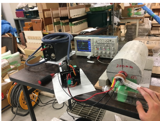
写真 5.5.2.2 電磁パルス法の測定装置
