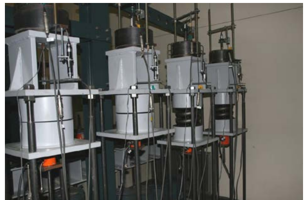
写真 2.2.2.1-8 クリープ試験状況
