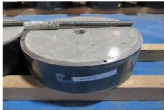
付写真 4.5.16 エポキシ樹脂 1-フィラー50%-④
