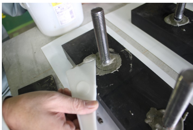
図 5.3.4.10 加力用鋼板内の無機系樹脂の注入状況
