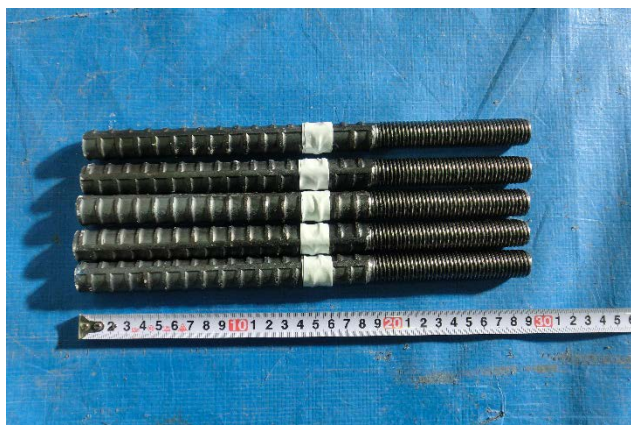
図 5.3.4.3 せん断実験に使用したアンカー筋
