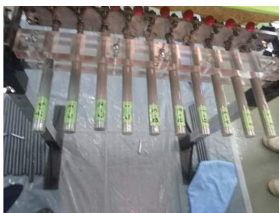
(e) 充填装置を90度回転して樹脂充填状況の確認を行っている様子
