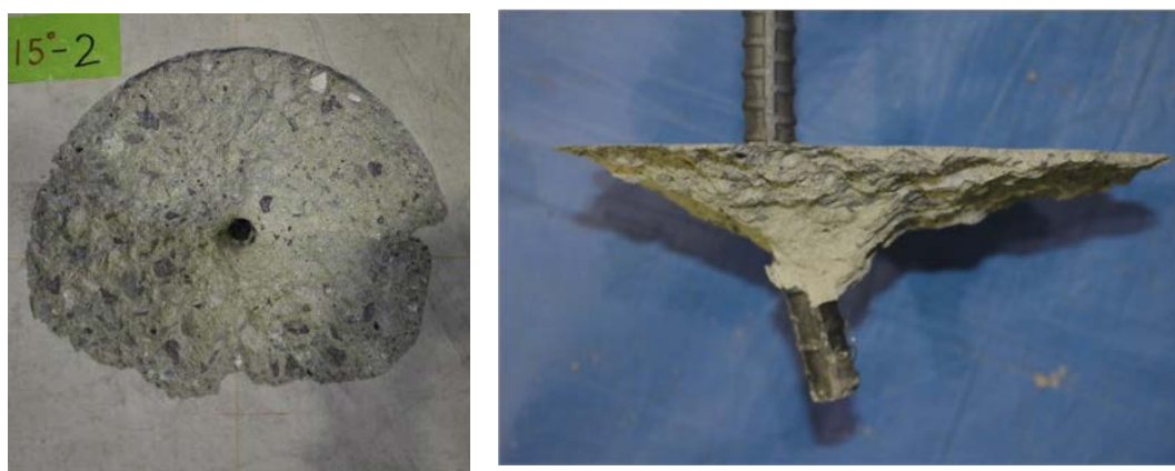
(d) 傾斜角 15^\circ のコーン状破壊形状
