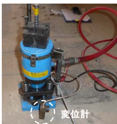
写真 5.2.3.4-8 変位計を取り付けた試験機
