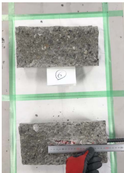
写真 5.5.2.6 接着剤充填状況(上向き樹脂量不足) 写真 5.5.2.7 接着材充填状況(清掃不良)
