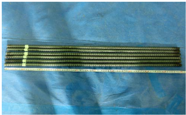
図 5.3.2.11 引張試験に使用したアンカー筋
