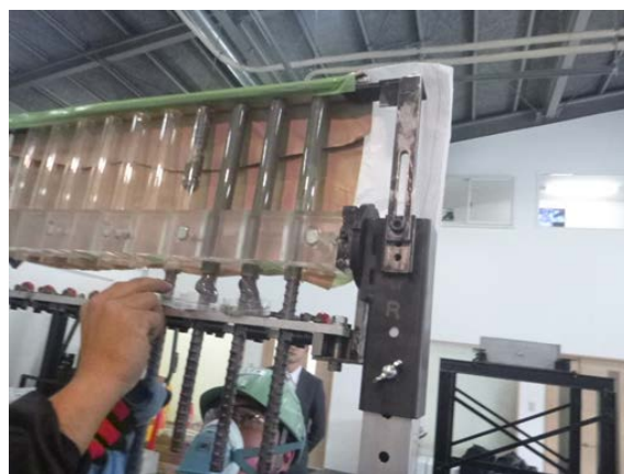
(d) 裏面の充填状況および余剰樹脂の様子
