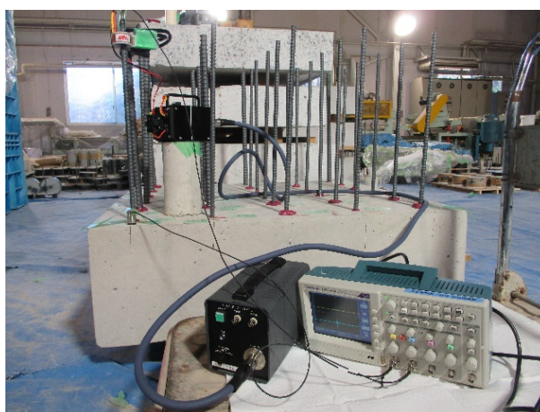
写真 5.5.2.3 電磁パルス法による測定状況
