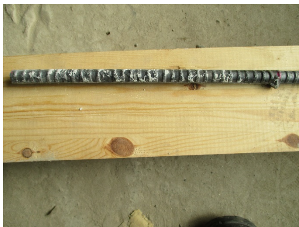
写真 5. 5. 3. 7 試験後のアンカー筋
