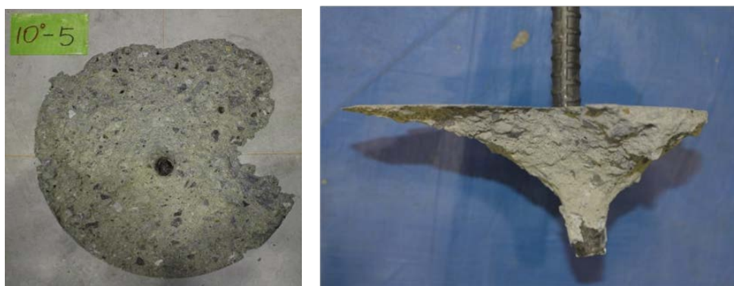
(c) 傾斜角 10^\circ のコーン状破壊形状
