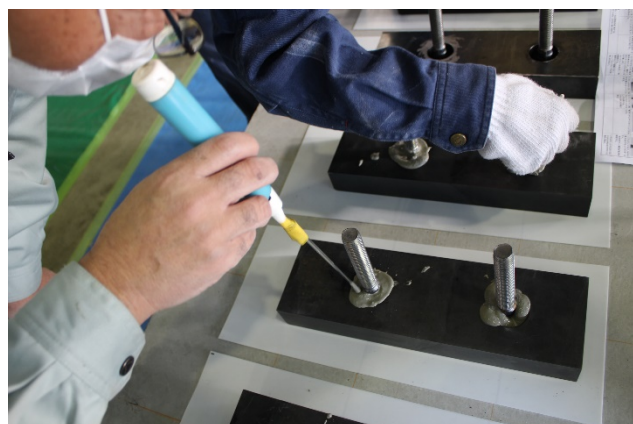
図 5.3.4.10 加力用鋼板内の無機系樹脂の注入状況
