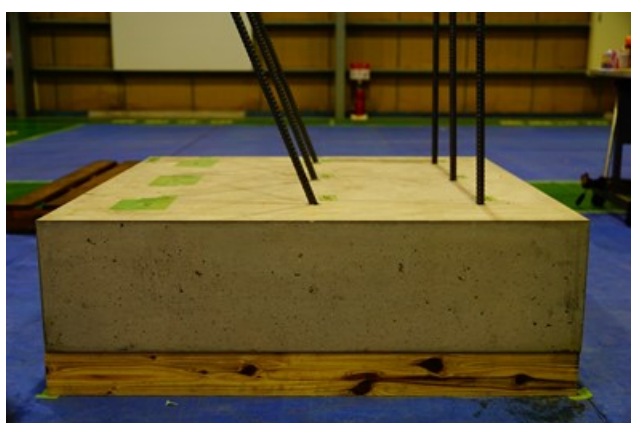
図 5.3.2.17 アンカー筋の設置状況(2)
