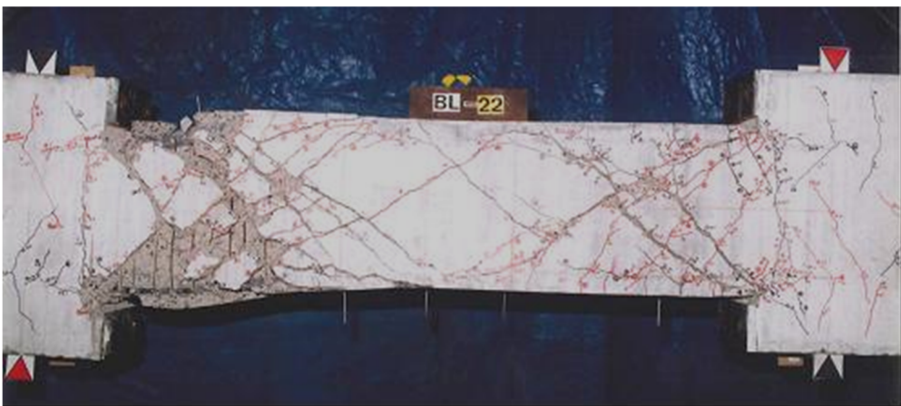
図 3.4.2 曲げ降伏後のせん断破壊に至った梁部材 (BL-22) の最終破壊状況
