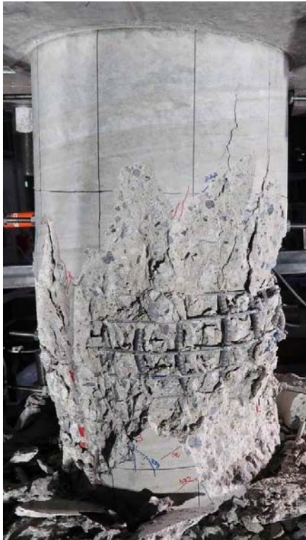
最終破壊状況（軸支持能力喪失）
