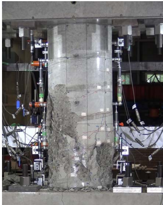
写真 4. 2. 1 試験体 N-3L の最終破壊状況
