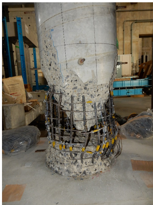
写真 4. 2. 2 破壊領域の研り出し
