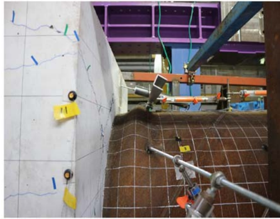
(試験体 No. 2 鋼管部座屈)
