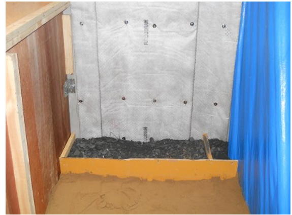
写真 7-25 試験体 No. 6 碎石投入状況
