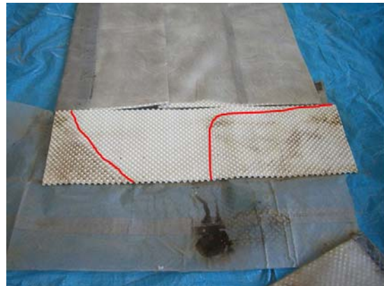
写真 3.4-3 透水マット内への 土砂混入状況（試験体 1, 透水マット(A)）
