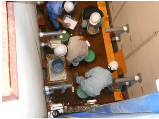
写真 2.6-2 排水水の重量測定状況
