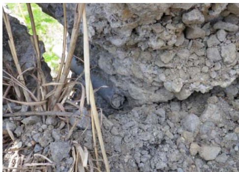
写真 1.1-1 再生砕石による不具合事例
