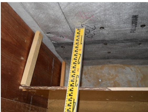
写真 7-23 試験体 No. 6 碎石投入スペース (厚さ 0.3m×高さ 0.5m)
