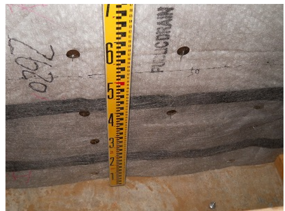
写真 7-23 試験体 No. 6 碎石投入スペース (厚さ 0.3m×高さ 0.5m)
