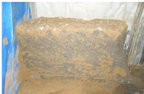
写真 4.3-2 再生砕石(RC-40)露出状況
