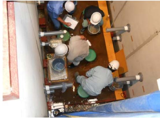
写真 2.6-2 排水水の重量測定状況
