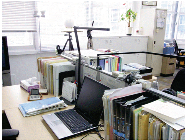
図 V. 2. 5. 10 照度計設置状況
