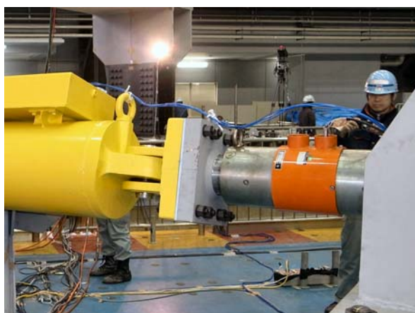
写真 2.3.2-4 ロードセル取り付けネジの回転
