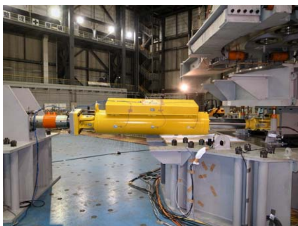
写真 2.3.2-3 ダンパー傾きの状況
