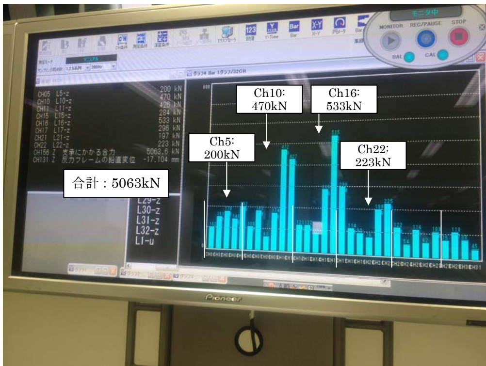
写真 2.2-1 5000kN 軸力導入時のリアルタイムモニター確認状況
