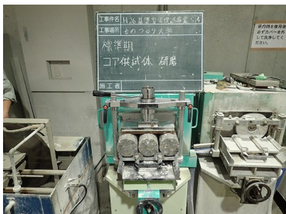
付写真 5-3 供試体の端面の研磨の状況
