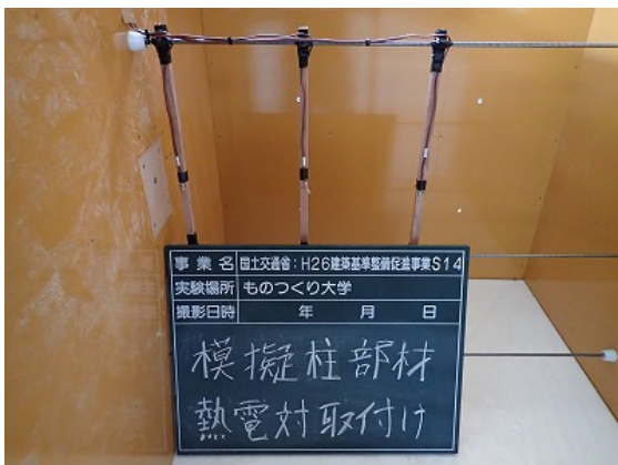
付写真 3-3 JASS 5 T-605 T 型熱電対の取り付け
