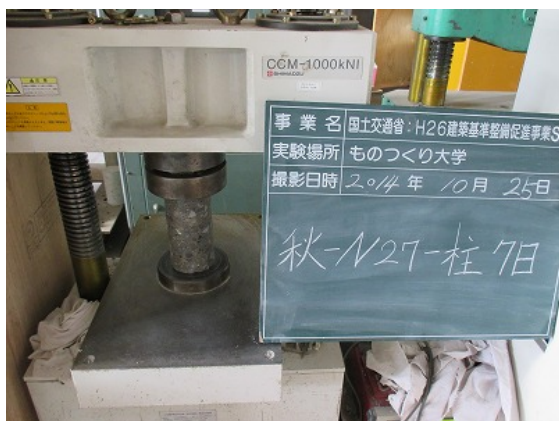
付写真 6-2 圧縮強度試験の状況
