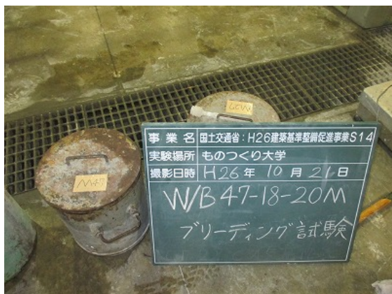
付写真 6-1 ブリーディング試験の状況
