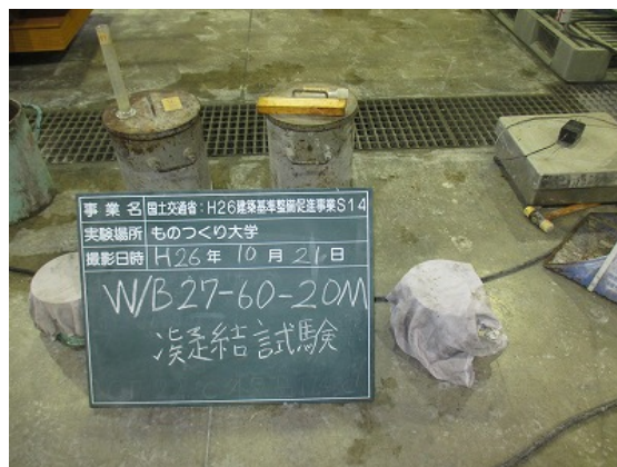
付写真 6-4 凝結試験の状況
