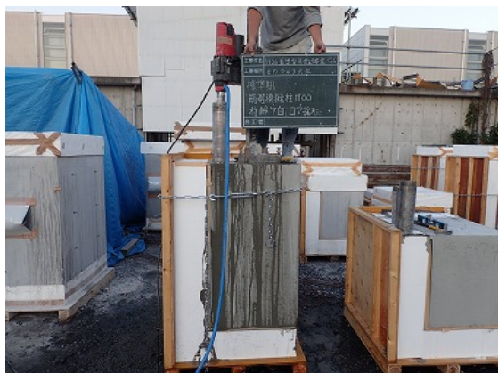
付写真 5-2 コア供試体の採取の状況
