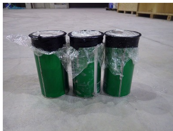
付写真 4-6 管理用供試体 (簡易断熱養生)
